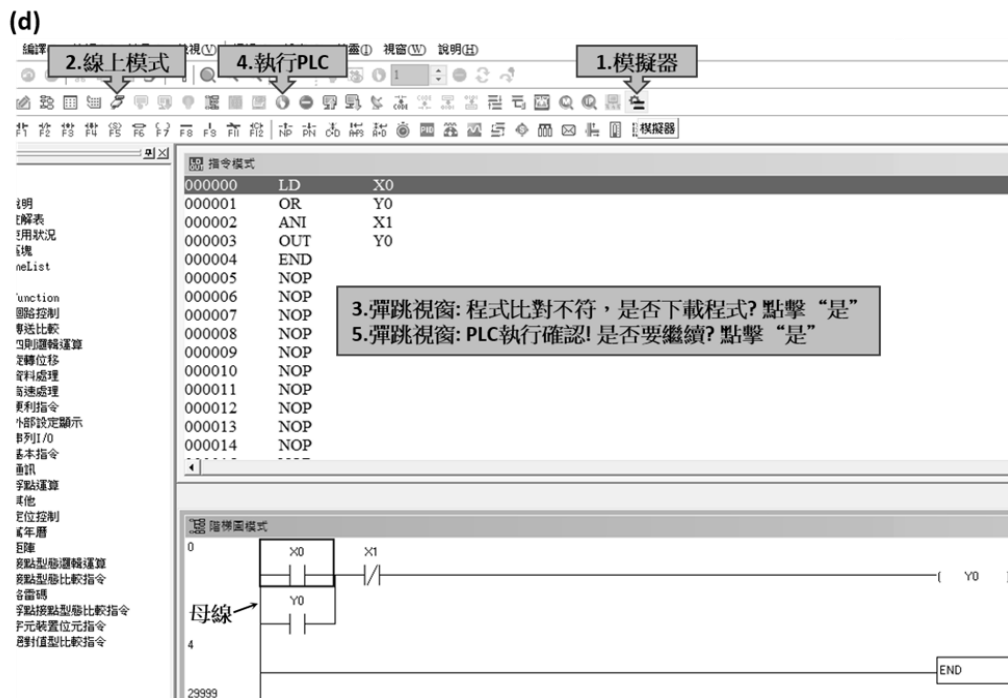
圖 7 藉由輸入簡碼指令來建立自保持電路之階梯圖的操作流程（續）
