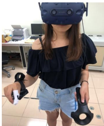
圖 20 按壓觸覺手套中的壓力感測器
