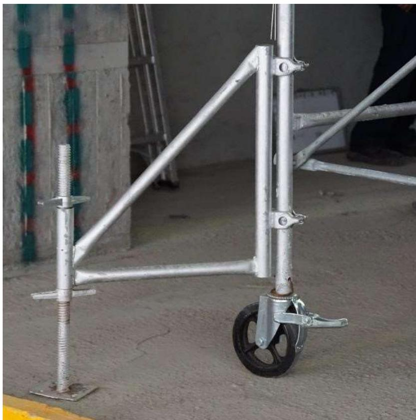
裝有腳輪之移動式施工架，
