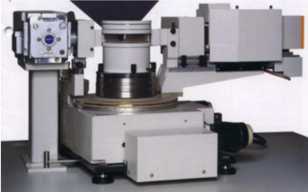
XRD的光源為X光，其使用X光管，如管電壓為60 kVp、管電流為300 mA、功率為18 kW，其屬於登記備查類可發生游離輻射設備。
