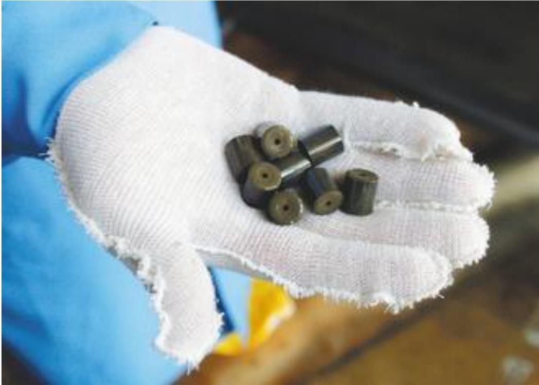
核能電廠所用的燃料為了承受運轉時1000°C以上的高溫，特別將鈾做成二氧化鈾(UO<sub>2</sub>)的粉末，再燒結成直徑與高度均為1.6 cm左右的柱狀「燃料丸」，然後再將燃料丸放入長約3.86 m，厚約0.8 cm的鋯合金管內，做成燃料棒。
