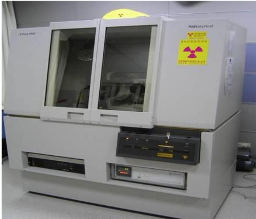
XRD使用X光管，如管電壓為45 kVp、管電流為40 mA、功率為1.8 kW，其屬於登記備查類可發生游離輻射設備。
