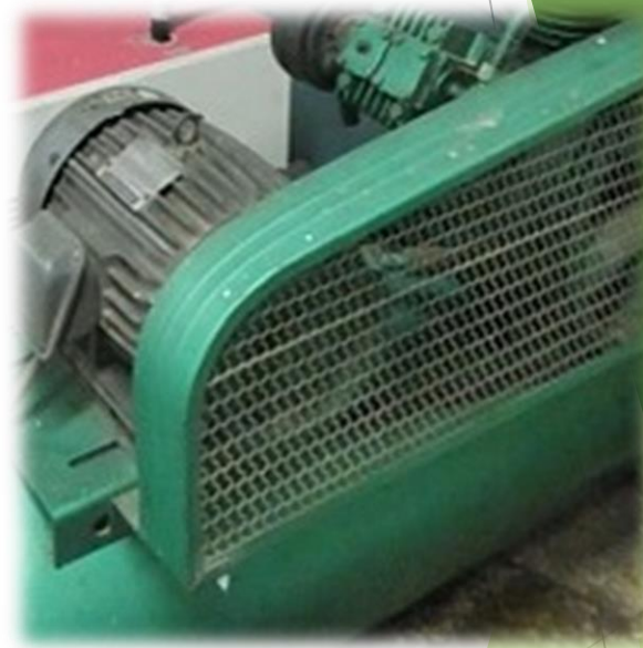
空壓機傳動裝置
