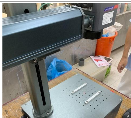
照片 6 說明：雷射設備(金屬打標機)
