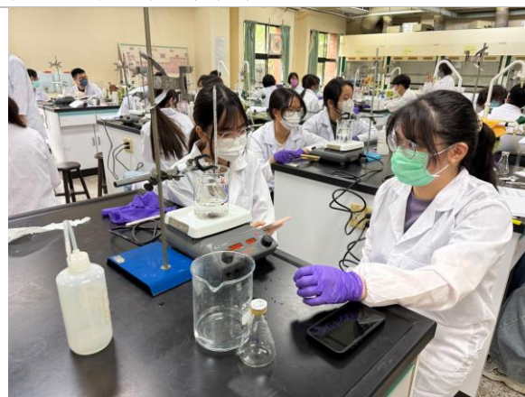
圖 2 學生檢查水浴加熱裝置、溫度計與錐形瓶架設，確認量測條件。
